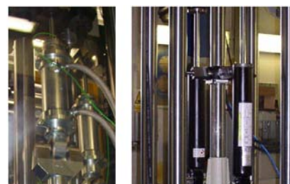
Испытание нескольких амортизаторов с оснасткой для бокового нагружения, измерения температуры и охлаждением воздухом/водой
