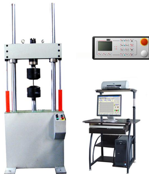
Универсальная сервогидравлическая машина для статических и динамических испытаний
