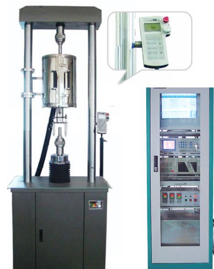
Электромеханическая машина для испытаний на ползучесть и длительную прочность
