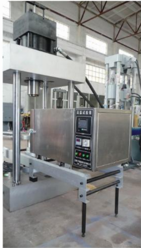
Силовая рама 500 кН (с камерой для пониженных температур)
