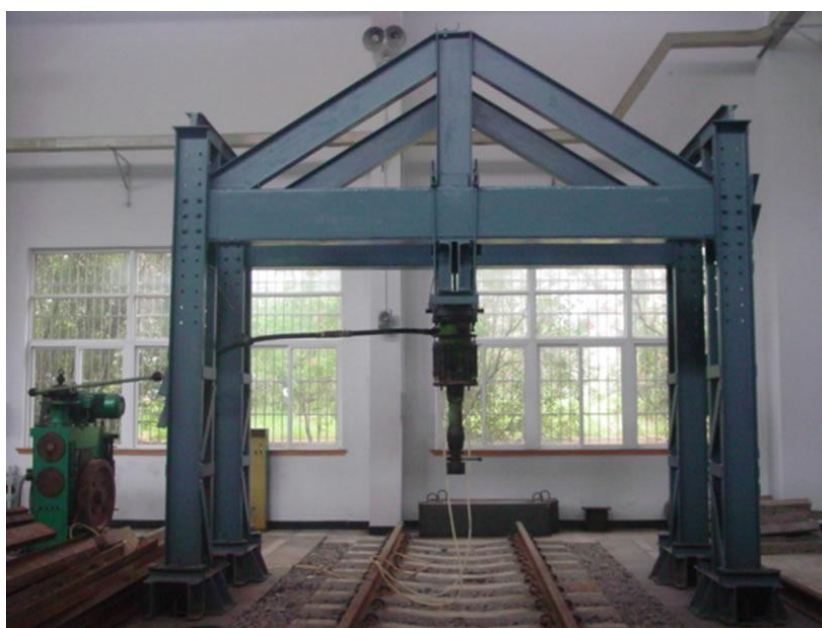
Усталостные испытания рельсовых путей на пульсаторе при растяжении-сжатии
